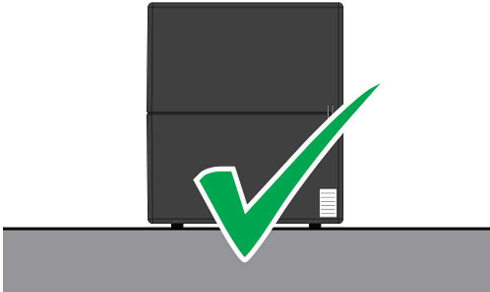
Correcte plaatsing iLumen iLubat op vlakke ondergrond
