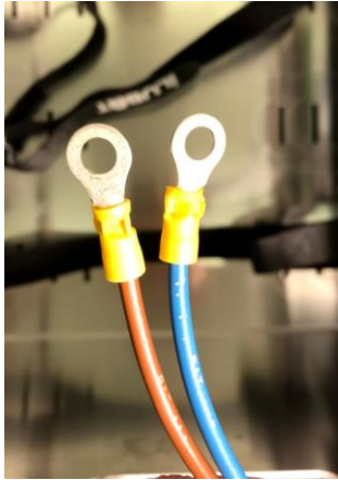
Verbindingskabel iLumen iLubat naar batterij
