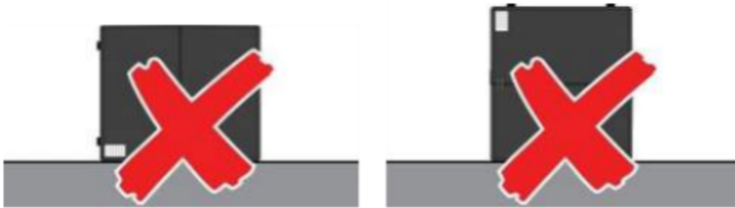
Foutieve plaatsing iLumen iLubat op vlakke ondergrond
